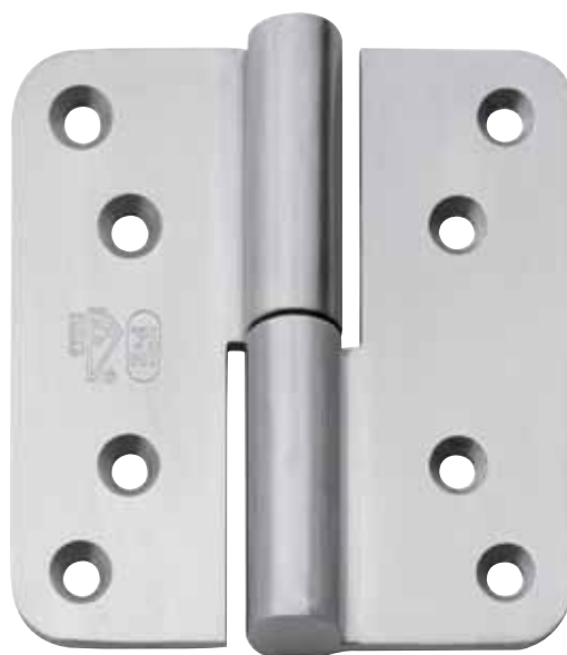
SC 5441 met houtschroeven 4,5 x 40 mm 2 stuks 100 kg deurgewicht en 3 stuks 130 kg deurgewicht
