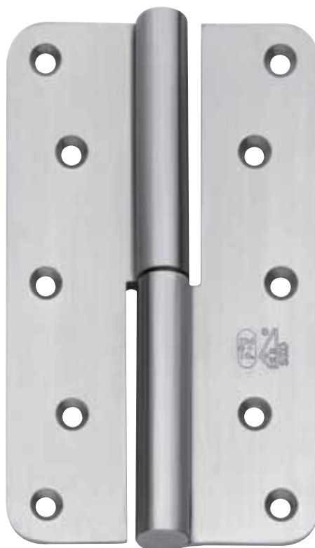
SC 5641 000 13L voor deurgewicht 80 kg (2 stuks) gebruikscategorie 3. Hoogtemaat 160 mm, schroeven zijn verder uit elkaar gepositioneerd, voorkomt splijting van hout.
