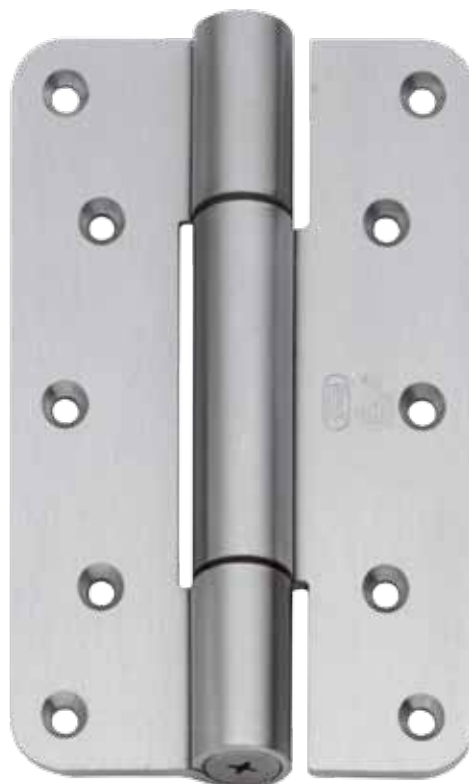
SI 5881 000 130 voor deurgewicht 200 kg (2 stuks) gebruikscategorie 4. Indien niet inbraakwerend SC 5881 000 130.
