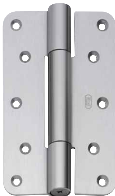
SC 5681 000 130 voor deurgewicht 150 kg (2 stuks) gebruikscategorie 4. Indien inbraakwerend SI 5681 000 130.
