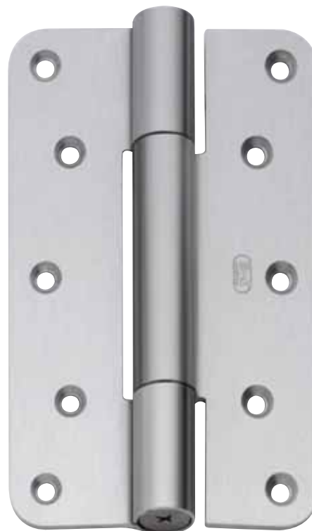
P+E TWIN-LINE® projectscharnier SC 5681 000 130 voor deurgewicht 150 kg (2 stuks) gebruikscategorie 4. Hoogtemaat 160 mm, schroeven zijn verder uit elkaar gepositioneerd. voorkomt splijting van hout.
